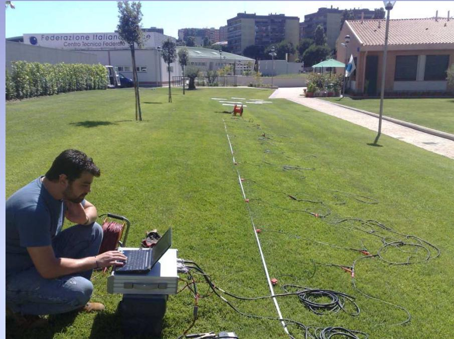
Sismografo a 24 canali in acquisizione
