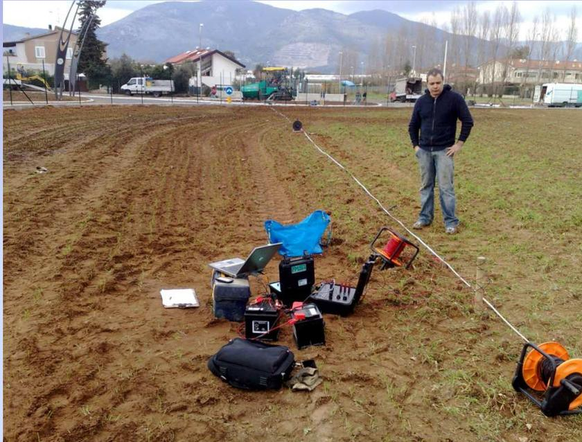
Fase di acquisizione del sondaggio elettrico verticale SEV
