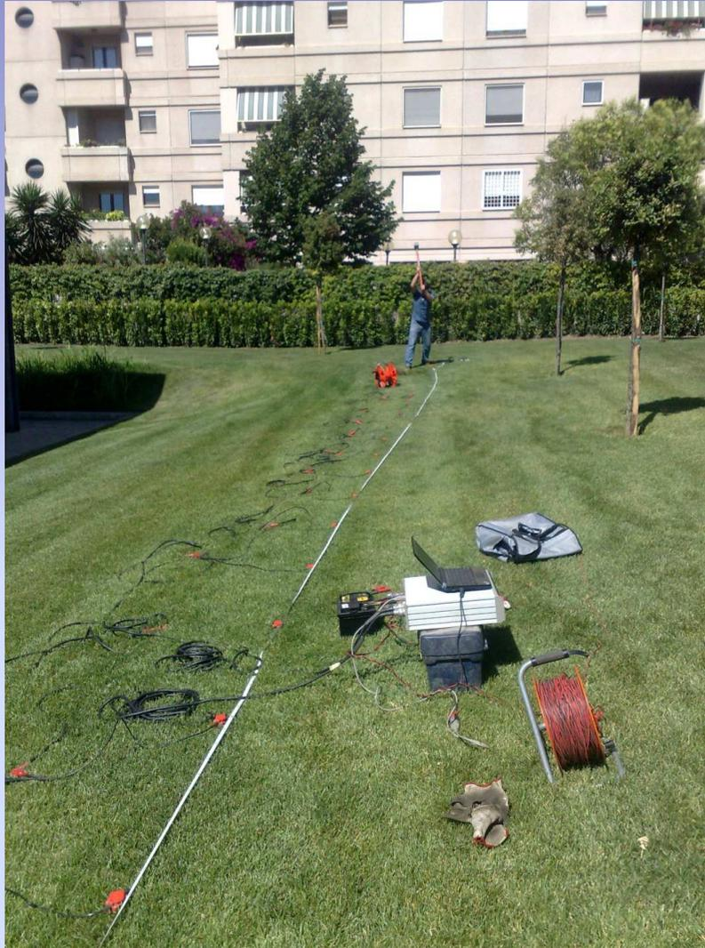
Esempio stesa sismica con processo di energizzazione con mazza battente
